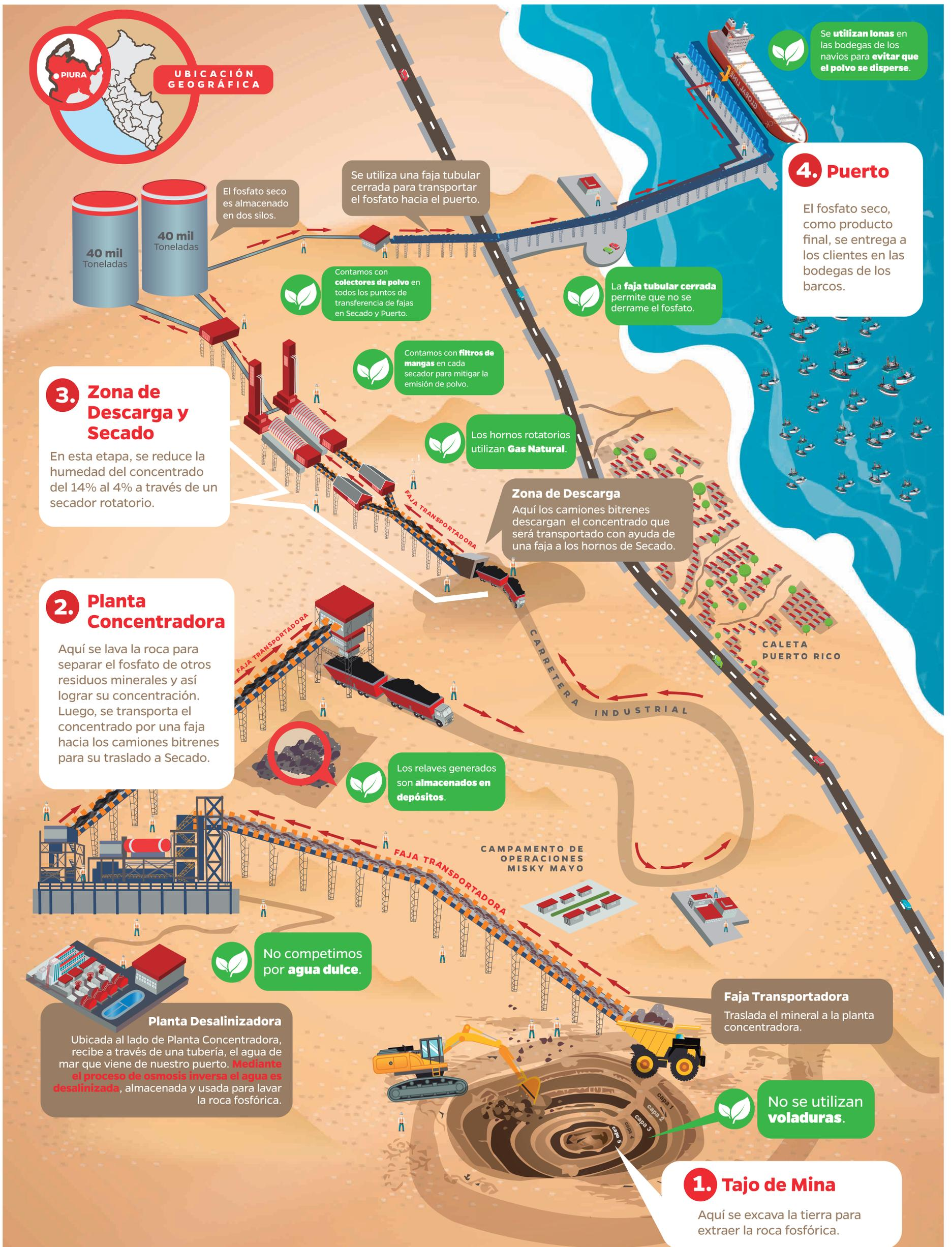
COMPONENTES DEL PROCESO DE EXTRACCIÓN DEL FOSFATO
