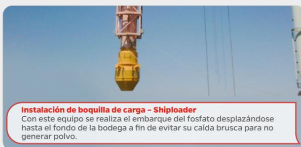
**Instalación de boquilla de carga - Shiploader**
